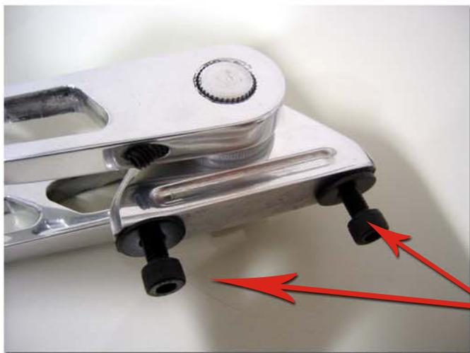
DEPOIS DE AJUSTADA A POSIÇÃO DOS BRAÇOS, DEVE-SE AGORA APERTAR O PARAFUSO ALLEN COM A CHAVE FORNECIDA NO KIT. PARA INSTALAR O ACELERADOR, FAÇA 2 FUROS NA PAREDE DE FOGO DO CARRO E UTILIZE OS PARAFUSOS FORNECIDOS PARA FIXAR O SISTEMA.
