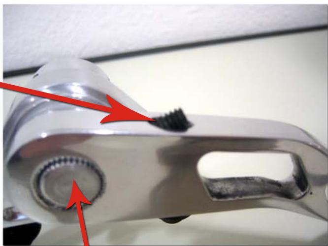
O EIXO DO ACELERADOR É ESTRIADO EM 360 GRAUS PARA QUE SE POSSA AJUSTAR LIVREMENTE A POSIÇÃO DOS BRAÇOS.
