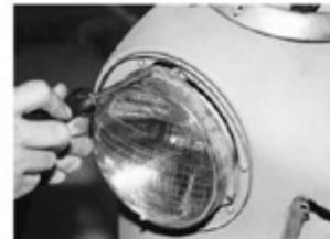
Remover o farol sealed-beam do veículo, tomando cuidado para não danificá-lo, pois este poderá ser utilizado normalmente no kit HOT EYES.
