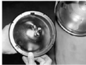
Pegue o aro de nylon onde há os chanfros internos. Veja como se encaixa na parte traseira do farol sealed beam.
