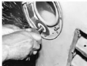
Estes parafusos, especialmente na linha GM que utilizava uma espécie de parafuso TORX, geralmente dão trabalho para serem retirados. Podem ser cortados, pois também não serão mais utilizados.
